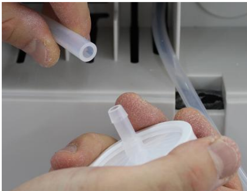
איור מס. 10 – מסנן בקטריאלי ישן מנותק מצינור שמאלי
