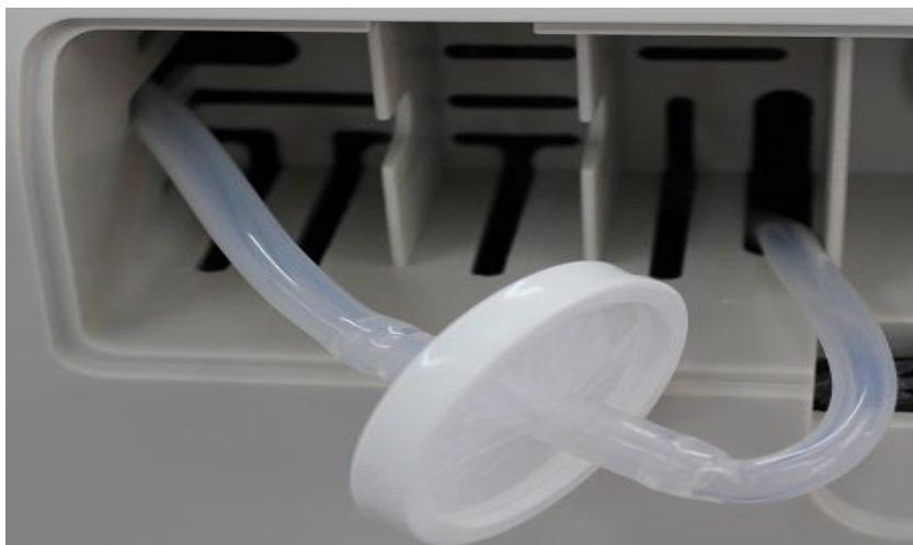
איור מס. 6 – מסנן בקטריאלי מחוץ למקומו
